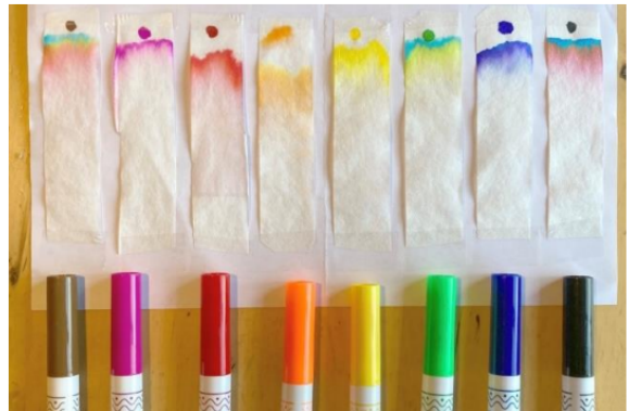
Figuur 17 Chromatografie van stiften door middel van water.
